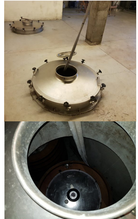
Figura 32 Boca superior de los depósitos de fermentación que se encuentran debajo, en la nave de fermentación en Dominio do Bibei. Fuente: https://gastroviajesruth.com/vino/dominio-bibei-ribeira-sacra/
