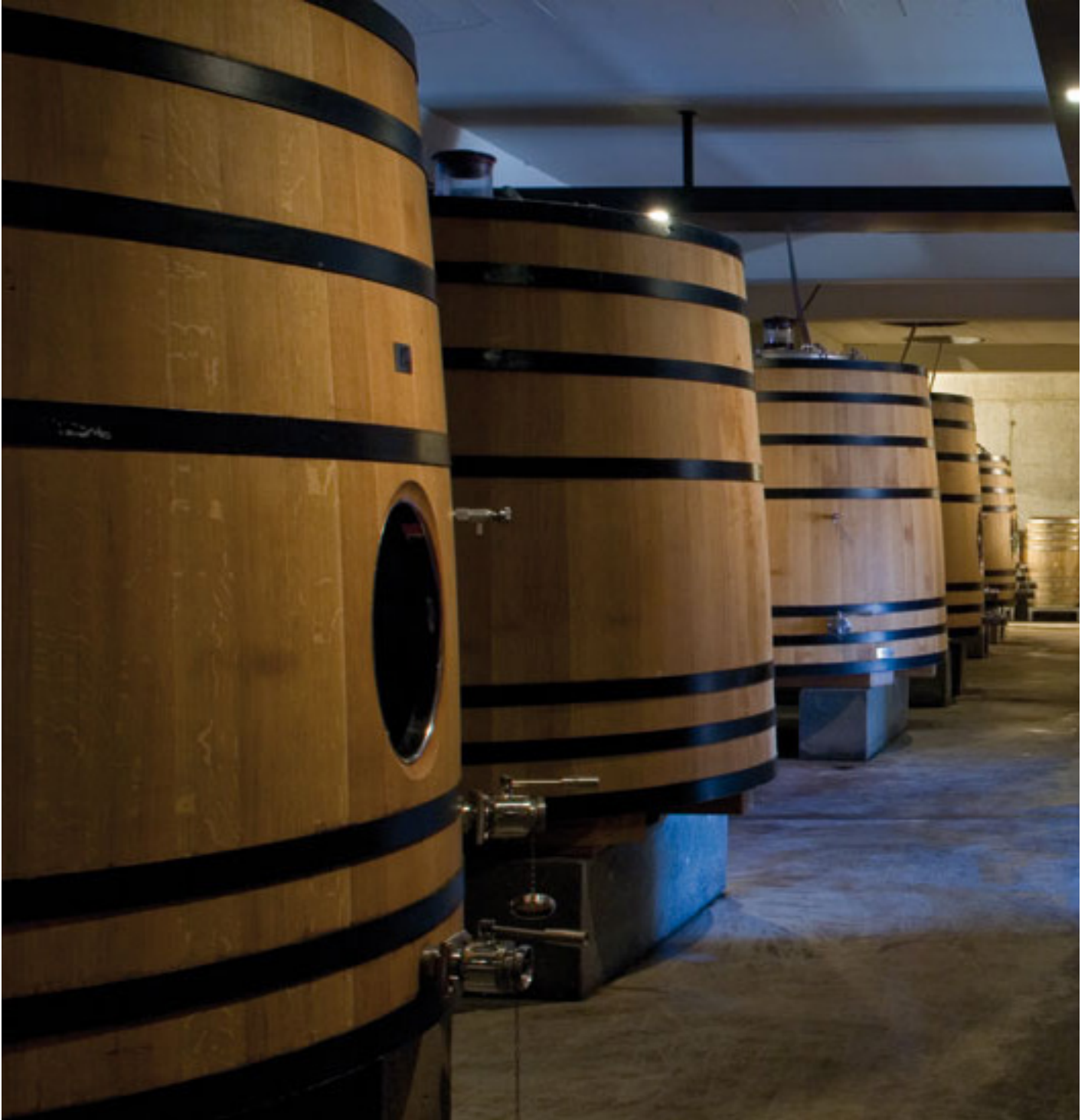
Figura 35 Depósitos troncocónicos de madera de roble francés para fermentación en Dominio do Bibei. A media distancia se aprecia la conexión mediante mangueras con la planta superior. Fuente: http://www.ondiseno.com/proyecto.php?id=2113
