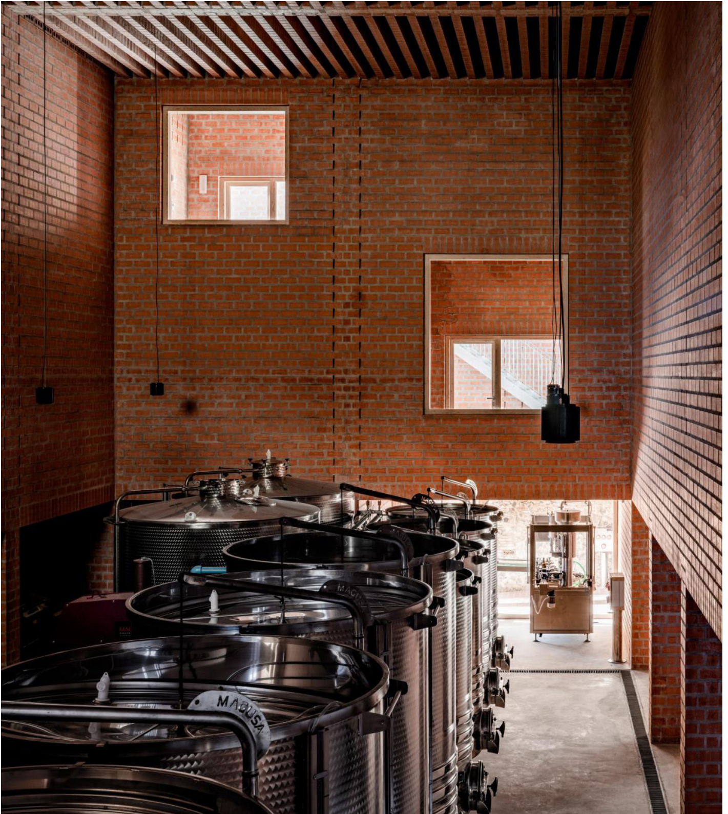
Figura 40 Depósitos de fermentación de acero inoxidable en Clos Pachem. Al fondo el receptáculo de la uva y la máquina embotelladora. Fuente: https://arquitecturaviva.com/obras/bodegas-clos-pachem-en-gratallops-tarragona
