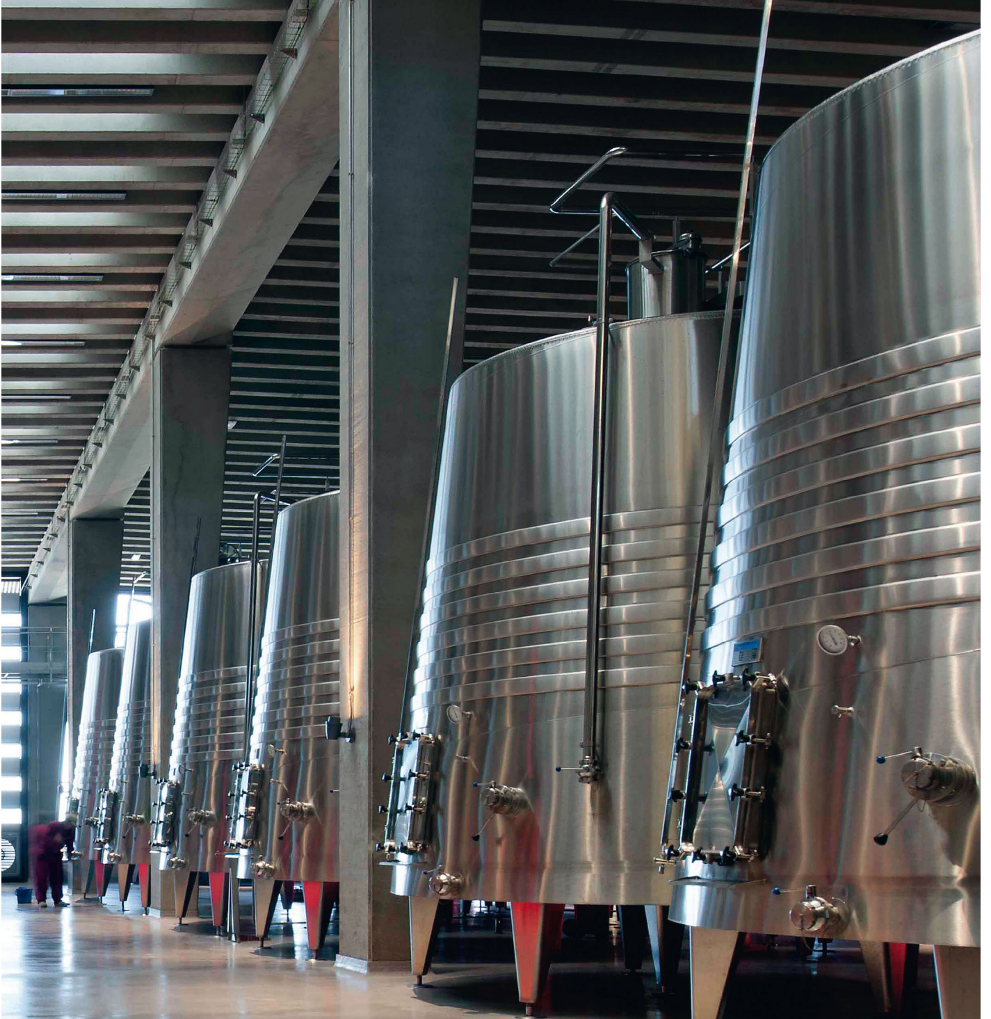
Figura 36 Depósitos troncocónicos de acero inoxidable para la fermentación en Bodegas Portia Fuente: https://arquitecturaviva.com/obras/bodegas-portia
