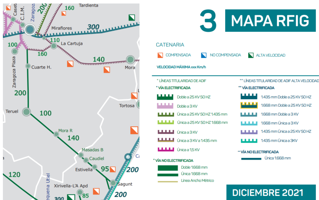
Fig 9. Velocidades máximas, tipo de electrificación y catenaria. Línea Zaragoza-Sagunto. Fuente: [7].
