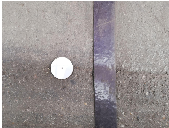
Imagen 1.2: Foto de un tag, y a su izquierda cinta magnética.
