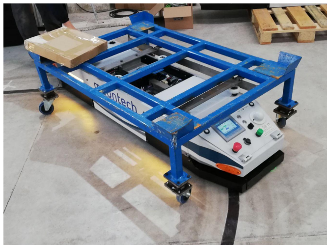
Imagen 1.3: Foto de un AGV llevando un carrito azul.
