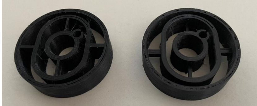
Figura 37. Prototipos fabricados con fabricación aditiva FDM en PLA.
