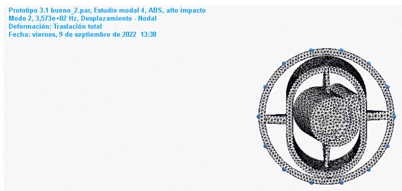
Figura 35. Simulación del prototipo para anchura de lámina 20mm, 655 Hz
