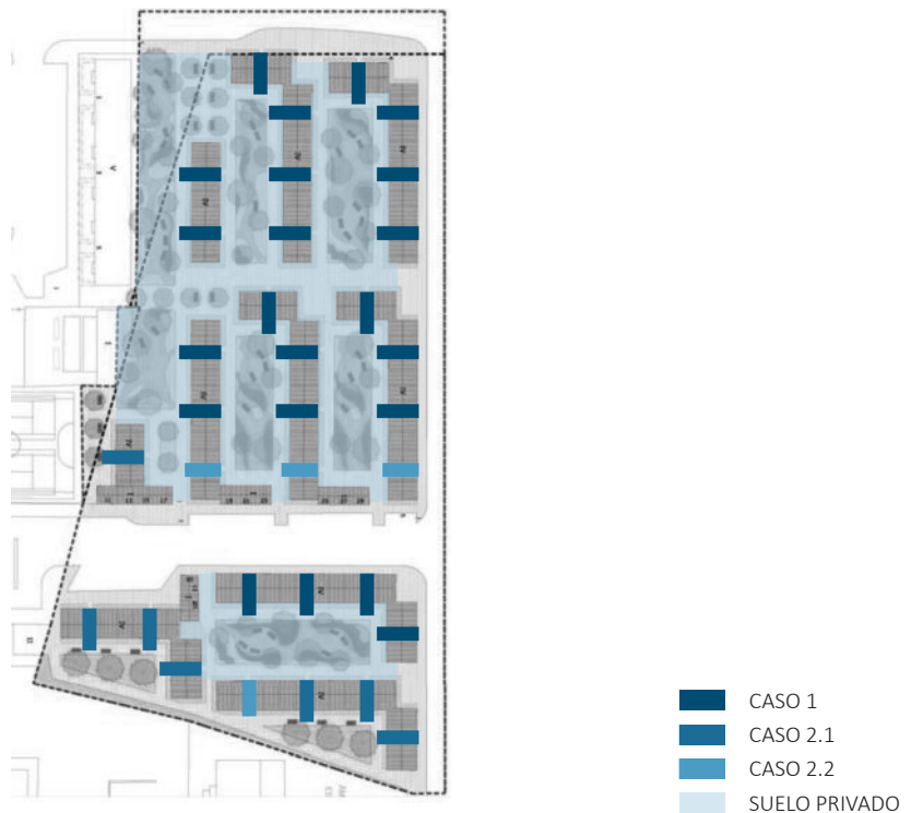
Figura 3.23: Estandarización de la solución en el Conjunto Teniente Ortiz de Zárate.
