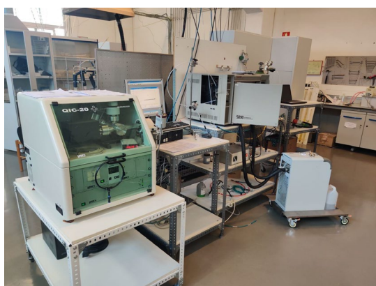
Figura 9. Sistema experimental de adsorción en lecho fijo
