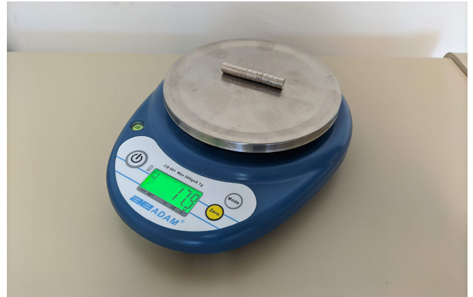
Figura 5: Caracterización del levitador. Proceso de medida de la masa del imán móvil. Para mejorar la precisión se miden varios imanes al mismo tiempo.
