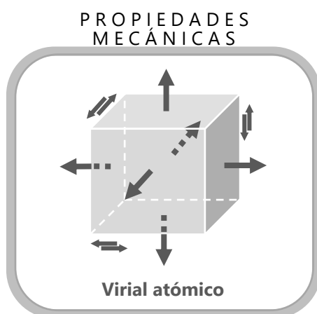
Figura 5 – Método para el cálculo de propiedades mecánicas y tipos de deformaciones aplicadas al modelo molecular.
