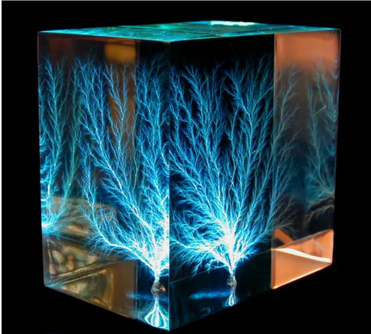
Las figuras de Lichtenberg son descargas eléctricas ramificadas que aparecen en la superficie o el interior de un material aislante. Se cree que el patrón de descarga se extiende como fractal aun hasta el nivel molecular. Tamaño real: 76 mm × 76 mm × 51 mm. Wikimedia commons
