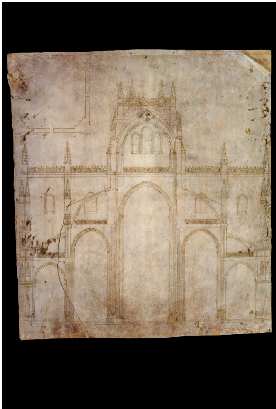
Fig. 114. Propuesta (en sección transversal) para el crucero de la catedral de Segovia atribuida a Rodrigo Gil de Hontañón ( ca. 1526-1527). Segovia (A.C.S., nº 6).
