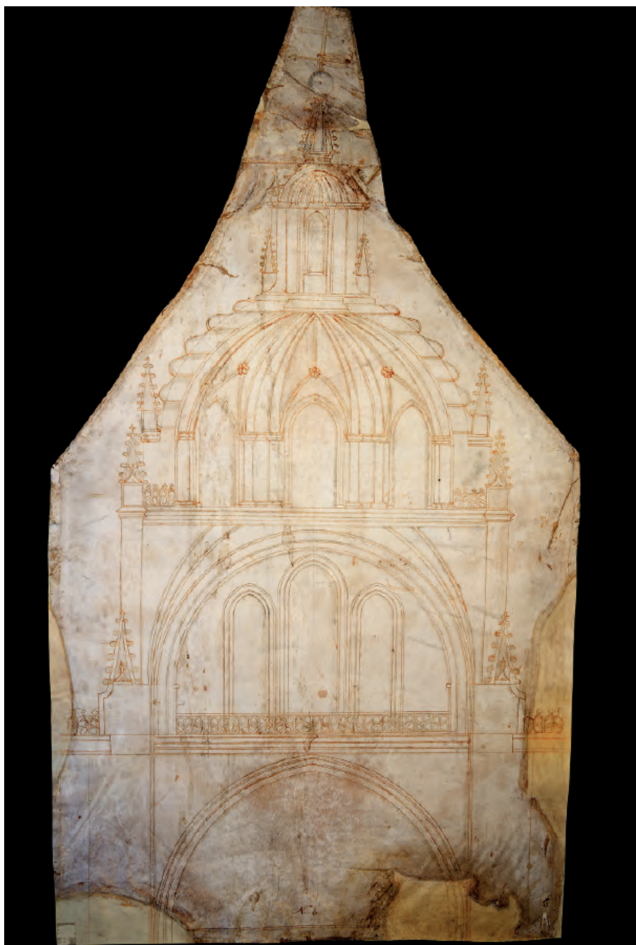
Fig. 164. Propuesta (en sección transversal) para el cimborrio de la catedral de Segovia, atribuida a Rodrigo Gil de Hontañón. Segovia (A.C.S., nº 8).
