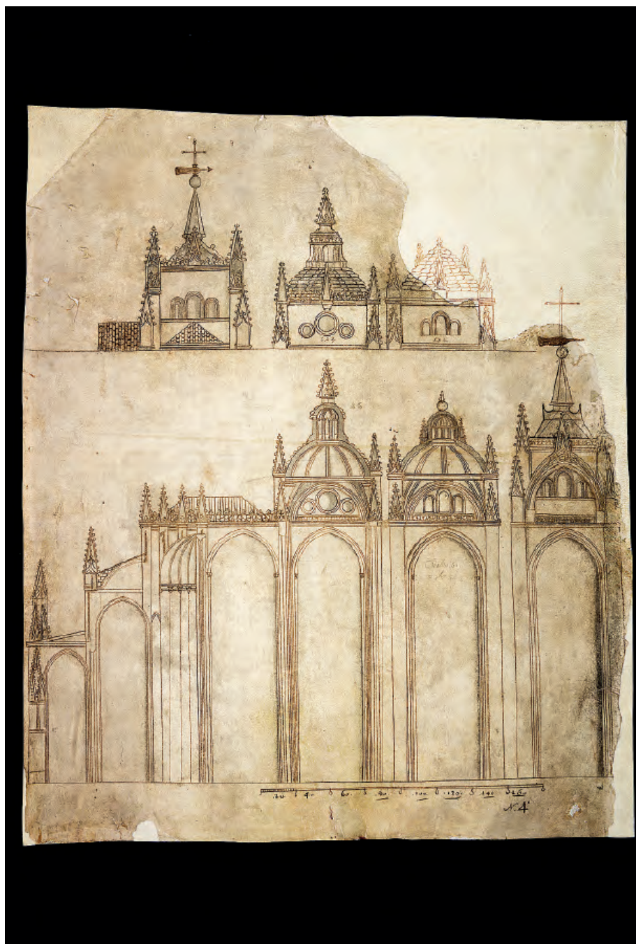
Fig. 166. Propuestas de secciones y alzados exteriores para el crucero de la catedral de Segovia. Segovia (A.C.S., nº 4).
