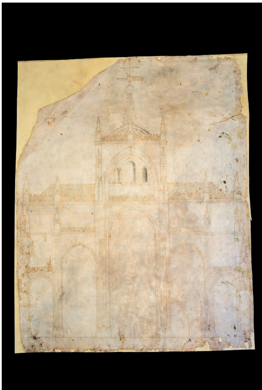
Fig. 112. Propuesta (en sección transversal) para el crucero de la catedral de Segovia atribuida a Juan Gil de Hontañón (1524). Segovia (A.C.S., nº 5).
