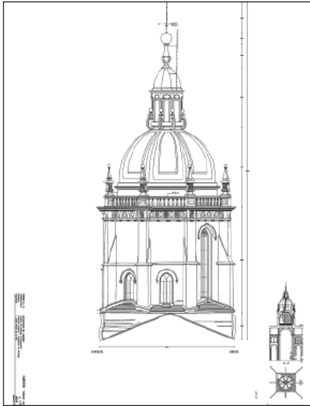
Figs. 75a y 75b. Alzado sur y alzado este del cimborrio de la catedral de Santiago de Compostela y su recrecimiento barroco (Javier Alonso de la Peña).
