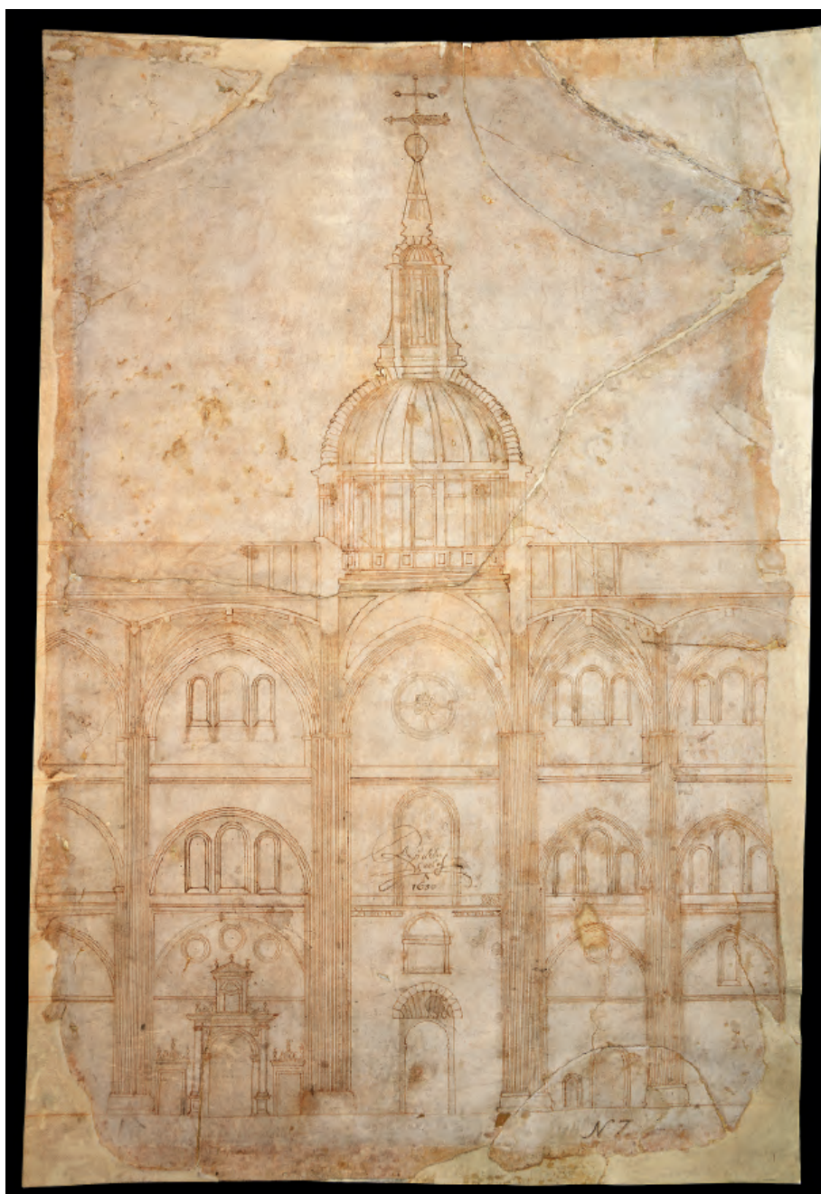
Fig. 177. Proyecto para el cerramiento del tramo correspondiente a la encrucijada del transepto de la catedral de Segovia presentado por Pedro de Brizuela en 1630. Segovia (A.C.S., nº 7).
