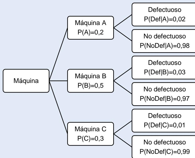
a)  $P(\text{Defectuoso}) = P(\text{Def}|A) \cdot P(A) + P(\text{Def}|B) \cdot P(B) + P(\text{Def}|C) \cdot P(C) = 0,02 \cdot 0,2 + 0,03 \cdot 0,5 + 0,01 \cdot 0,3 = 0,022$
