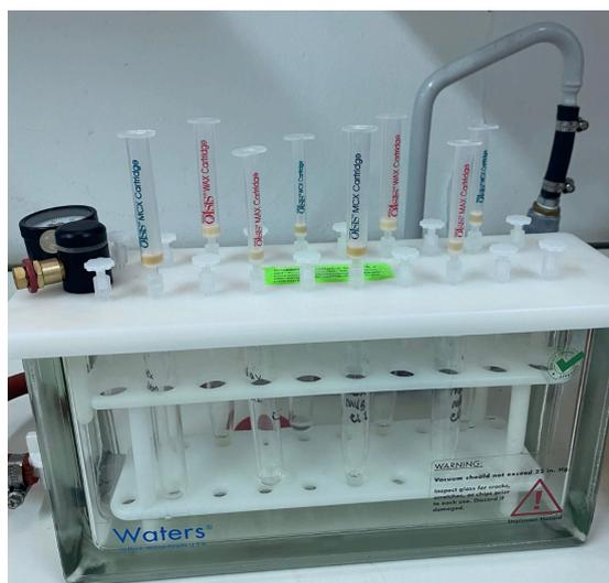
**Figura 9.** Manifold® con cartuchos MCX, WCX, MAX y WAX utilizadas para extraer patrones de sueros.
