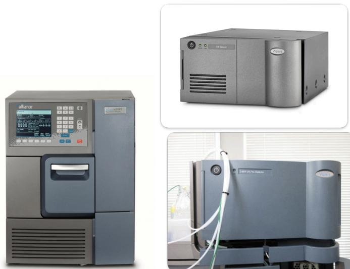
**Figura 7.** Equipo HPLC utilizado para los experimentos (foto de la izquierda) y detectores ultra-violeta visible 2489 y de fluorescencia 2475 (fotos de la derecha).
