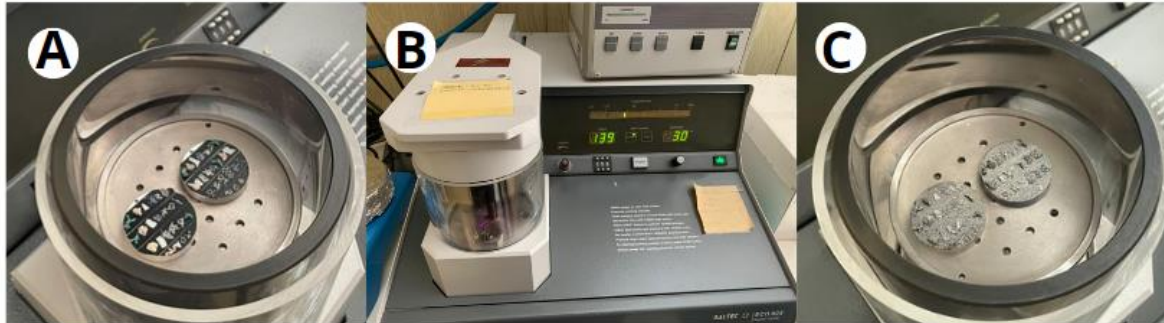
Figura 26: Muestras colocadas en el recubridor (A); Recubridor cerrado y en funcionamiento (B); Muestras recubiertas por oro palacio (C). Fuente: Propia
