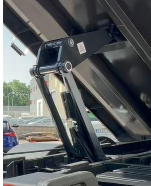
Figuras 1 y 2. Actuación del sistema basculante de tijera en un modelo real
