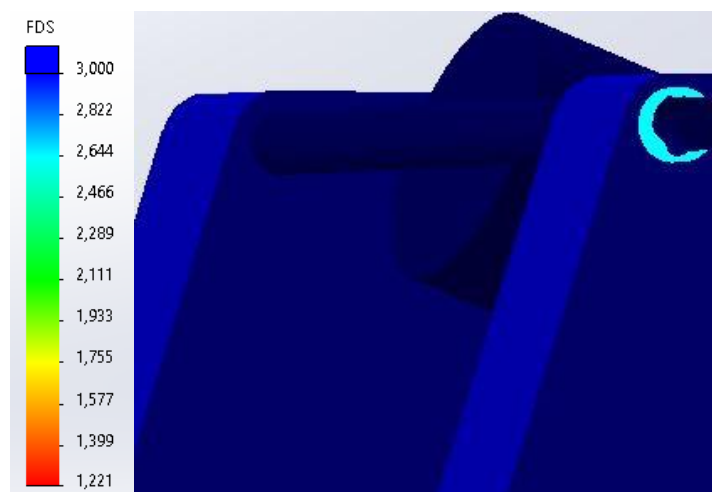
Figura 58. Factor De Seguridad en la unión articulada C
