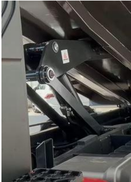
Figuras 1 y 2. Actuación del sistema basculante de tijera en un modelo real
