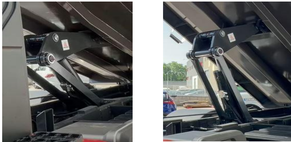
Figuras 1 y 2. Detalle del inicio de la elevación de la caja (izq) y de un instante cercano al final de la descarga (der)
