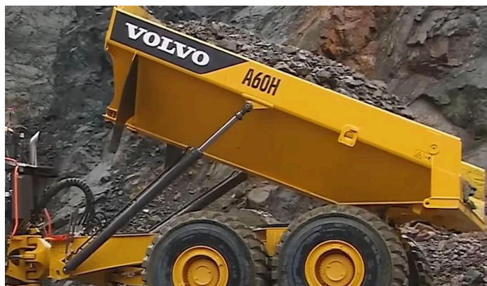
Figura 162. Detalle del sistema de elevación del Volvo A60H
