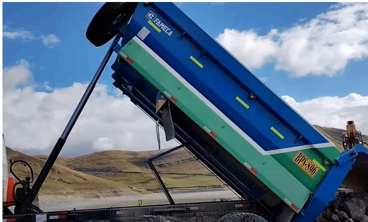
Figura 160. Detalle del sistema de elevación del Volvo FMX 480
