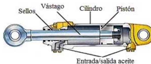
Figura 281. Elementos que componen un cilindro hidráulico
