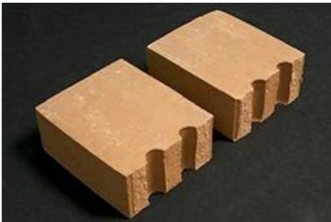
Fig.45: Proceso de división y modificación artesanal de cada pieza de ladrillo para el revestimiento.
