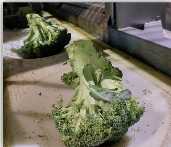
Figura 8. Platos cóncavos para la introducción del brócoli en la cortadora (Fuente: elaboración propia).
