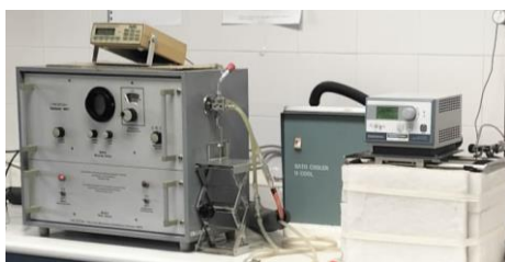
Figura 2. Dipolómetro modelo WTW DM01 (izquierda abajo) termostatizado con un termostador HAAKE modelo F3 (derecha) junto con un refrigerador NESLAB tipo U-cool (centro atrás), temperatura del sistema medida por un termómetro Digi-Sense Cole Palmer (izquierda arriba).
