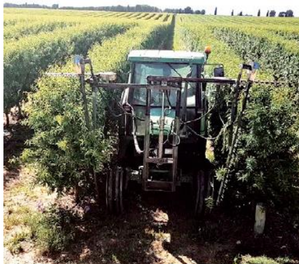
Figura 6 Poda en verde mecanizada, tanto de los laterales como de la copa, de ciruelos adultos. Fuente: Iglesias, I., Torrents, J., Zúñiga, M., Marzo, C., & Giori, M. (2021).
