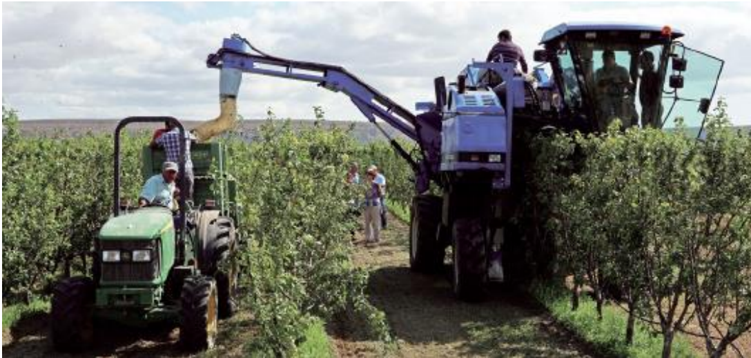
Figura 17 Recolección con maquina cabalgante de la ciruela variedad "Claudia de Tolosa" en la Finca Experimental del INTIA de Sartaguda (Navarra). Fuente: Iglesias, I., Torrents, J., Zuñiga, M., Marzo, C., & Giori, M. (2021).
