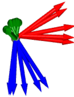
Figura 38: resultado de la composición consecutiva de matrices para el ejemplo de rotación de 45^\circ
