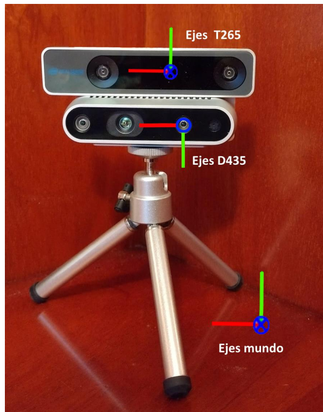
Figura 19: ejes de referencia de cada cámara y de las nubes de puntos 3D
