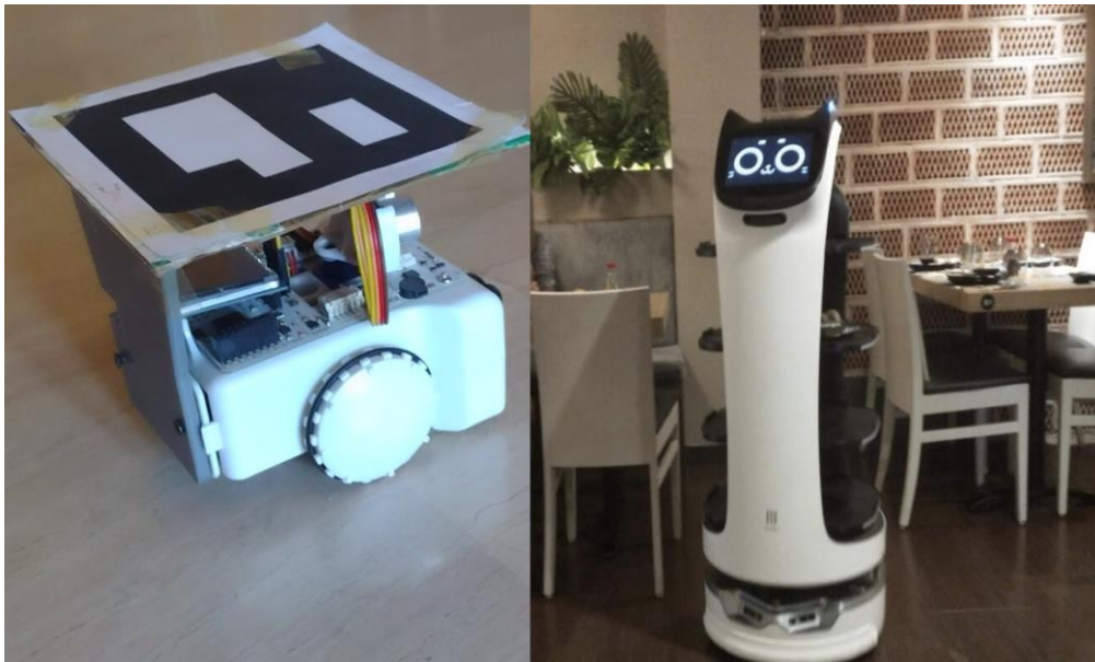
Figura 37: diferencias de diseño entre robots, a la izquierda robot Sparki, a la derecha robot BellaBot (Fuente imagen robot Bellabot: https://barcelonacolours.com )
