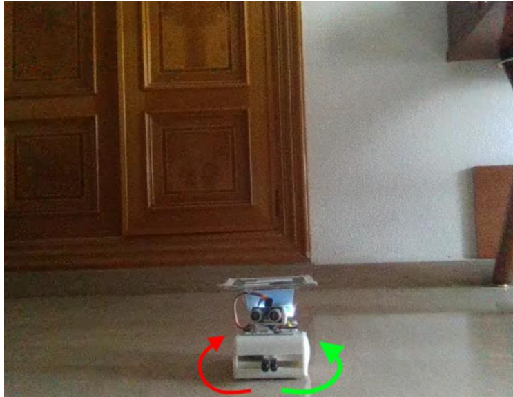
Figura 29: Robot Sparki con las flechas de los sentidos de las rotaciones puras a aplicar
