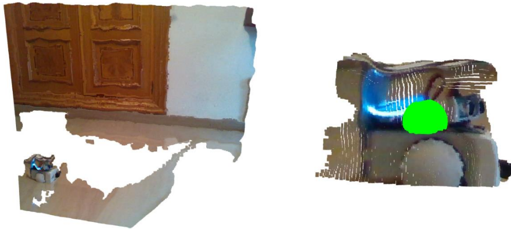
Figura 25: Esfera verde representando el centroide de la superficie detectada del robot Sparki, comparación con la escena global
