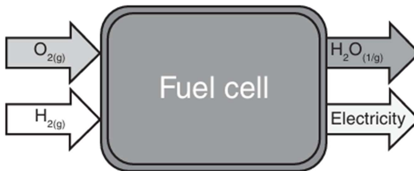
Ilustración 3. Esquema Pila (Fuente: Fuel Cell Fundamentals)
