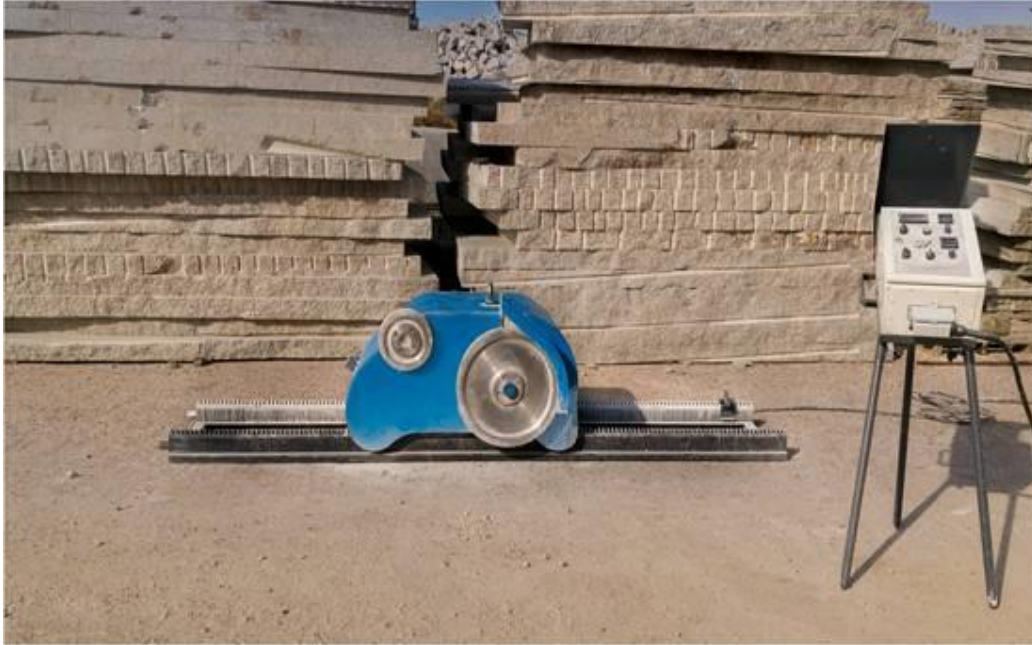
Ilustración 43: Equipo de corte por hilo adiamantado (peso:500KG). Fuente:[46]
