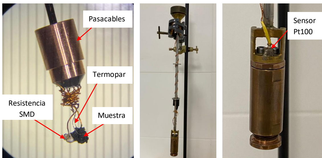
Figura 7: Izquierda: Imagen del pasacables de CuBe y del calorímetro junto con la muestra. Centro: Varilla de inserción. Derecha: Imagen de la celda de CuBe cerrada y atornillada a la varilla de inserción.
