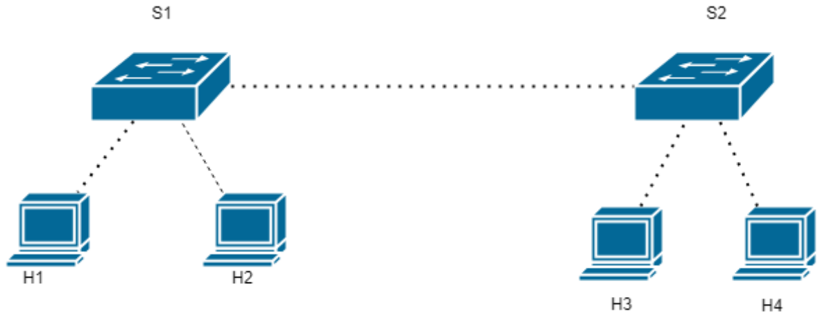
Figura 4.1: Infraestructura de red TSN emulada sobre Mininet en el TFG.
