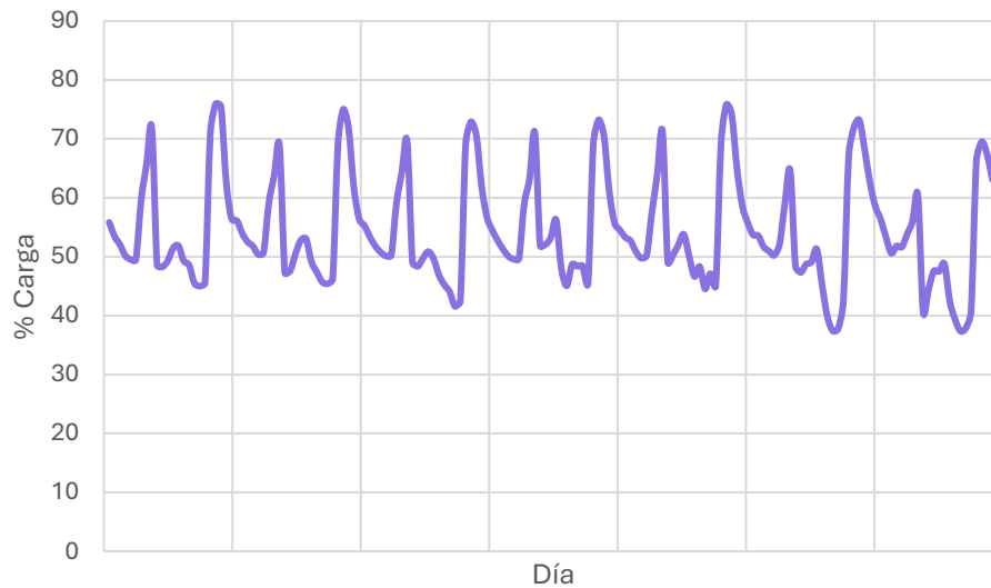
Ilustración 31 Niveles de carga máxima de las líneas de la red con seis VE cargando de forma simultánea en la fase B en la semana analizada
