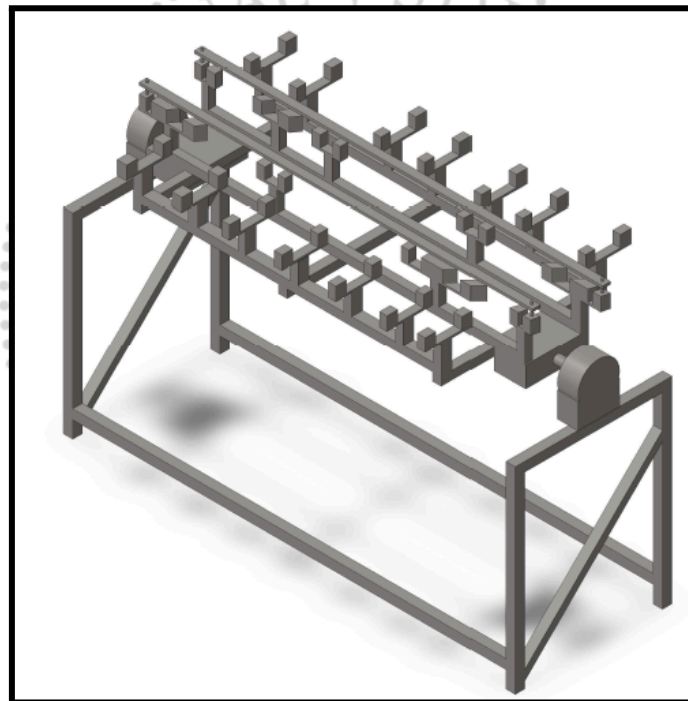
Figura 46. Útil de soldadura sin pieza de la estructura.
