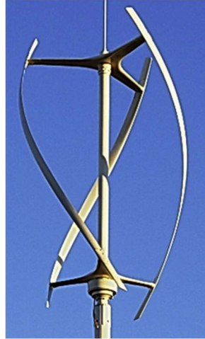
Fig. 13. Helicoidal H-rotor (Tjiu et al., 2014)
