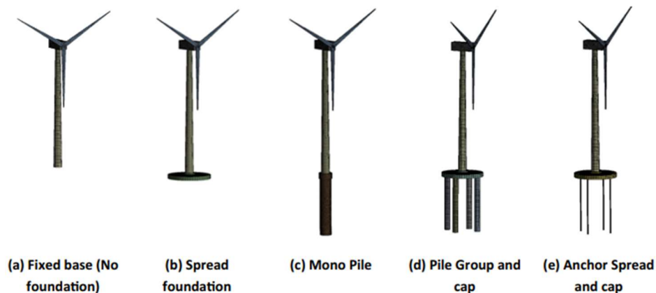
Fig. 27. Tipos de cimentación para aerogeneradores terrestres(Austin & Jerath, 2017)
