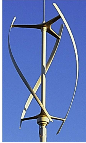
Fig. 13. Helicoidal H-rotor (Tjiu et al., 2014)
