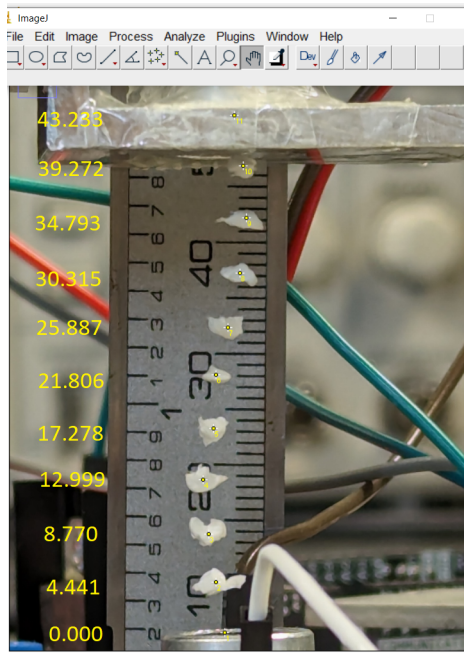
Figura 3.8: Medida de las posiciones utilizando ImageJ
