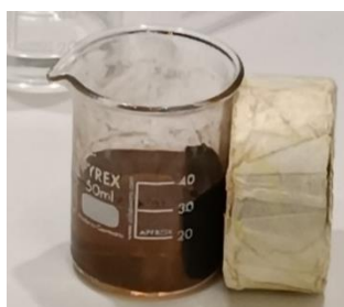
Figura 2. En la imagen se aprecia cómo las nanopartículas quedan pegadas a la pared del vaso donde se coloca el imán.
