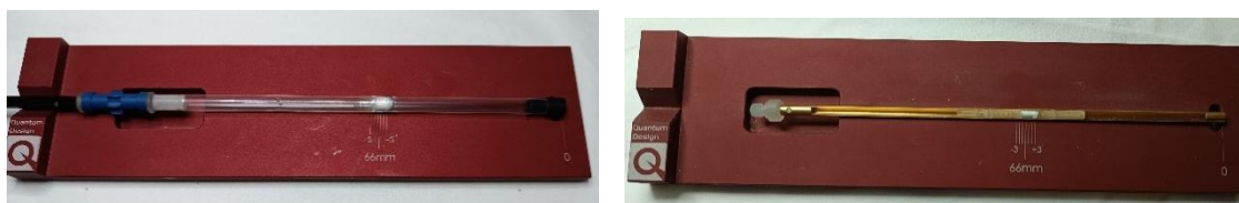
Figura 9. Imágenes de las muestras ya preparadas para medir con cápsula y pajita (izquierda) y en portamuestras de latón (derecha). En ambos casos se puede ver la regla usada para el centrado.
