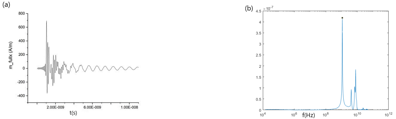
Figura 20: (a) Magnetización en el eje x frente a tiempo, excitación con función seno cardinal o sinc (que es una sinusoidal dividida por su argumento). (b) Transformada de Fourier.
