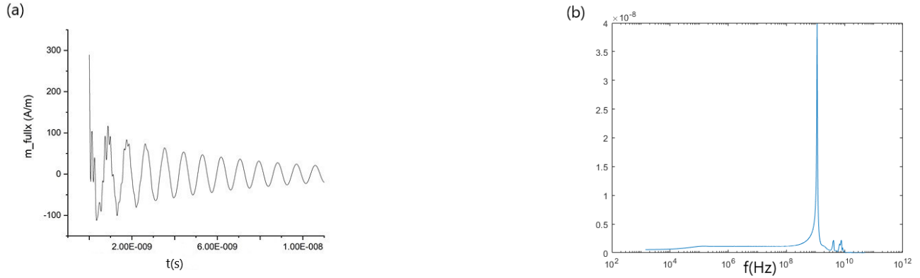
Figura 21: (a) Magnetización en el eje x frente a tiempo, excitación escalón, caso 3 discos. (b) Transformada de Fourier.
