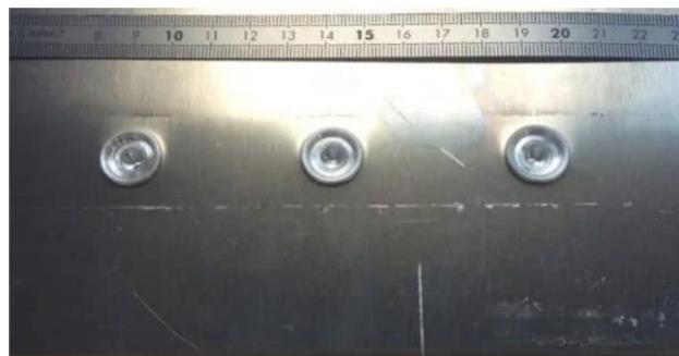
Figura 19: Soldadura por puntos: sustitución de la soldadura por resistencia
