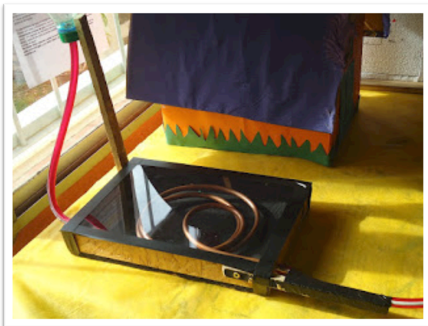
Colector solar fabricado por alumnos. segundosifd2012.blogspot.com.es
