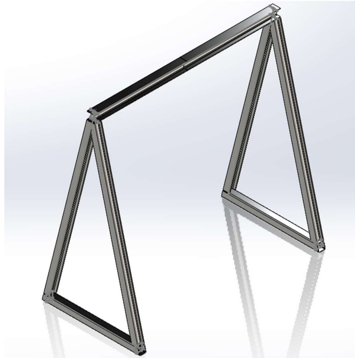
Figura 34. Modelo de uniones soldadas en SolidWorks
