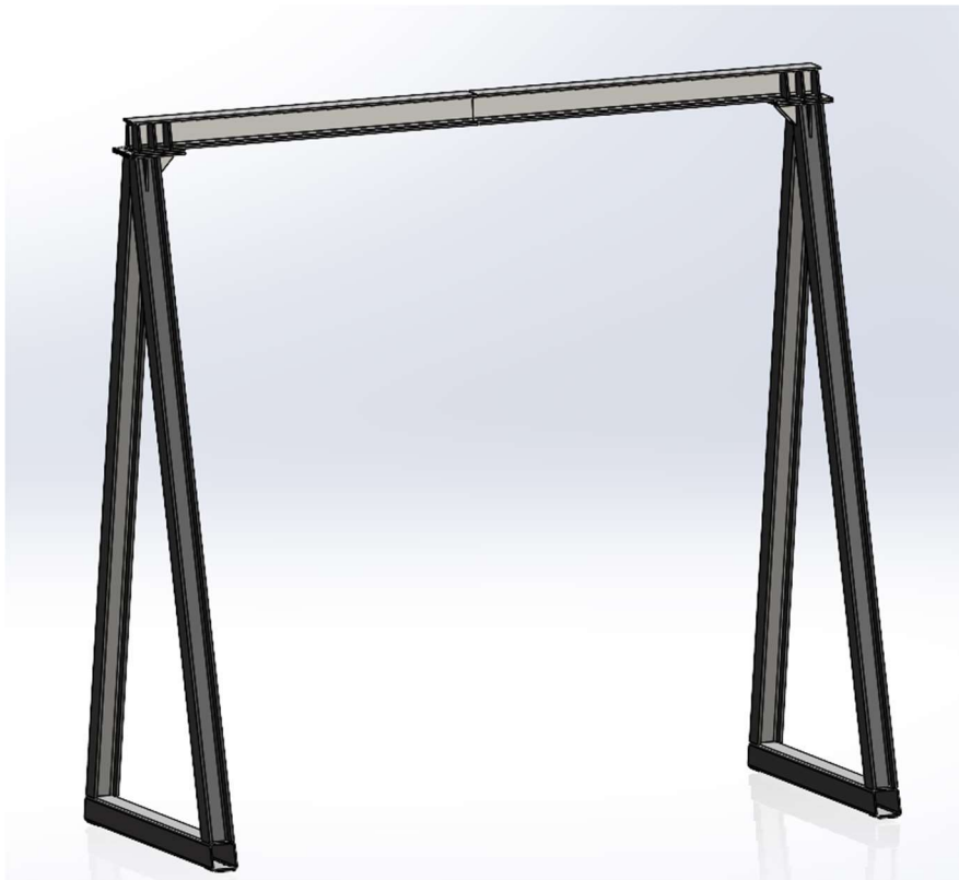
Figura 39. Modelo de uniones atornilladas con rigidizadores en SolidWorks
