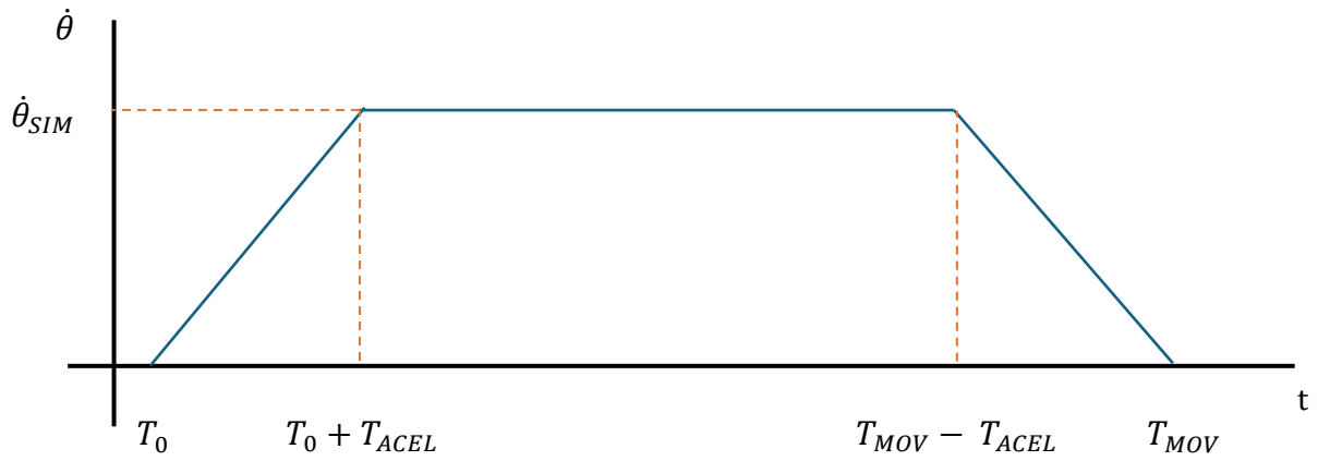
Fig. 19 Perfil velocidad trapezoidal para la posición angular de los ejes
