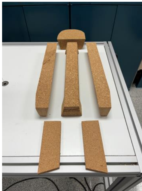
Figuras 21: Núcleo de corcho cortado
