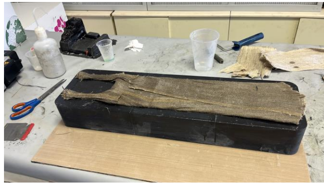
Figuras 22 y 23: Capa de lino bajo el núcleo y estructura sándwich montada
