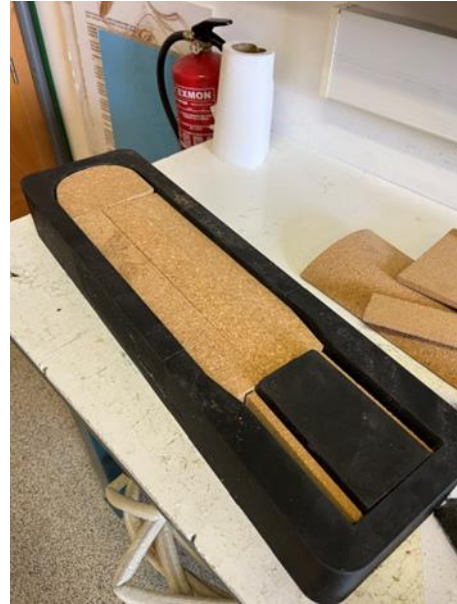
Figuras 19 y 20: Molde pegado y núcleo de corcho
