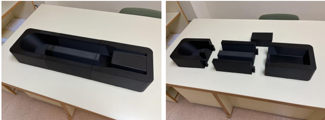
Figuras 17 y 18: Molde para la fabricación del prototipo
