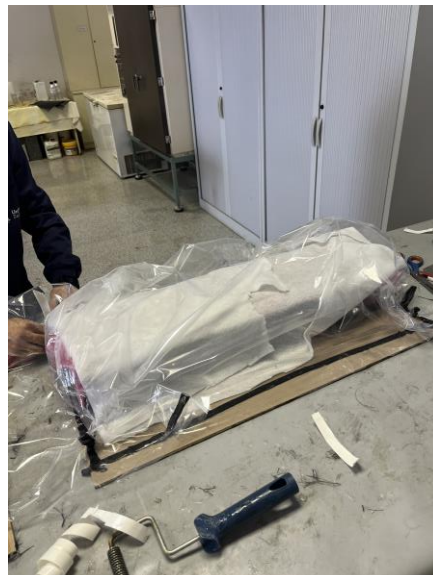
Figuras 24: Compresión de las capas por vacío
