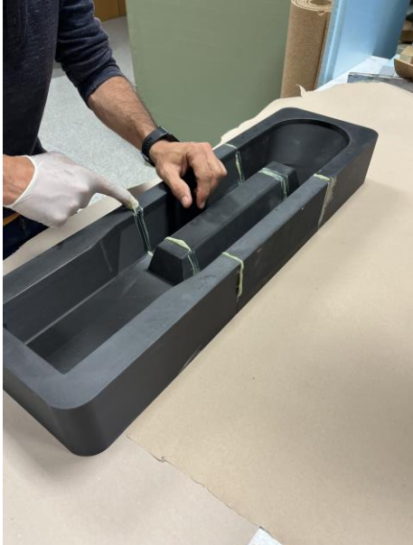
Figuras 19 y 20: Molde pegado y núcleo de corcho
