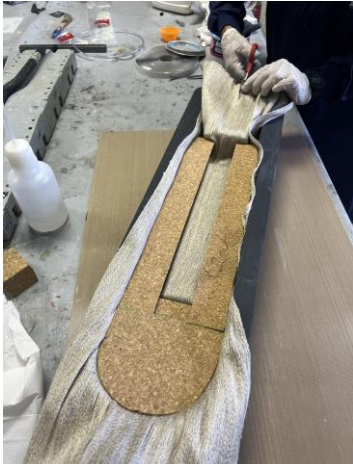
Figuras 22 y 23: Capa de lino bajo el núcleo y estructura sándwich montada
