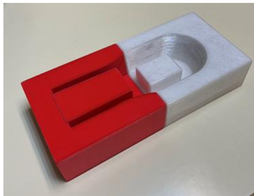
Figuras 18 y 19: Molde impreso para la prueba
