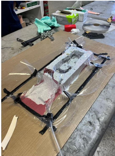
Figura 20: Vacío para la prueba del molde
