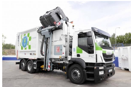
Figura 08. Contenedor carga lateral descarga
