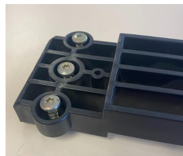
Figura 33. Detalle patín 1ª generación listo para el montaje
