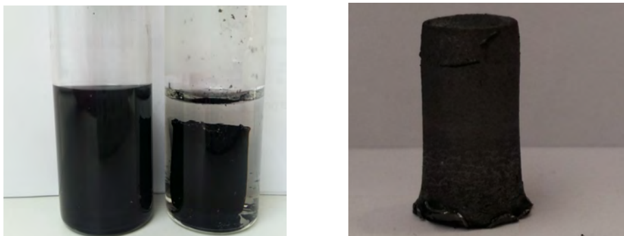
(a) Disolución de GO y \text{NH}_4\text{OH} (izqda) e (b) Aerogel de óxido de grafeno dopado con N hidrogel de óxido de grafeno reducido tras el tratamiento hidrotérmico (dcha).
