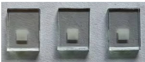
Figura 2.11: Ánodo: electrodos de \text{TiO}_2 .
