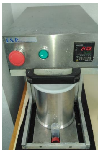
Figura 3.6. Desintegrador de laboratorio (pulper).
