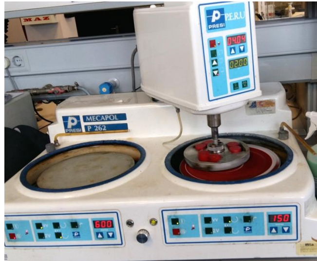
Figura 3.12. Pulidora Presi mecapol P 262.
