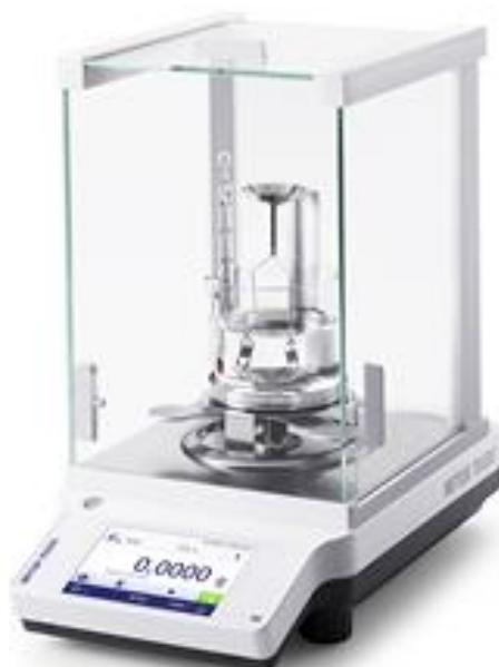
Figura 3.18. Balanza Mettler Toledo con accesorio para la determinación de la densidad de sólidos.
