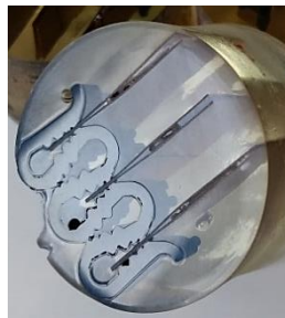
Figura 3.13. Superficie muestra obtenida tras el proceso de desbastado y pulido.
