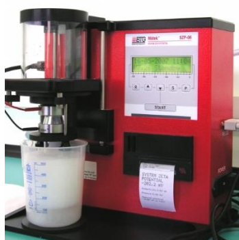
Figura 3.21. Equipo para la medida de Potencial Z en la pasta de papel.
