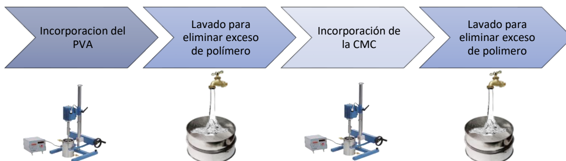
Figura 3.11. Esquema del procedimiento de trabajo para la incorporación en capas de polivinilamina y carboximetilcelulosa.
