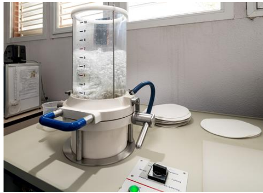
Figura 3.7. Equipo de preparación de hojas de ensayo Rapid Köthen.
