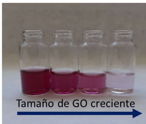
Figura 5. Estabilidad de las dispersiones en función del tamaño de partícula de GO. De izquierda a derecha, P3HT con GO sonicado 4 h, 2 h, 1 h y sin sonicar.
