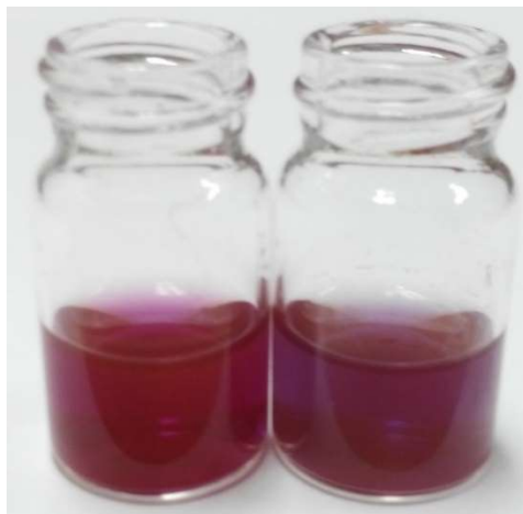
Figura 1. Fotografía de una dispersión de nanopartículas de P3HT con NCC-I (izquierda) y NCC-II (derecha) en proporción 1:2.
