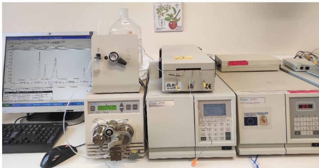
Figura 1.12. Análisis por cromatografía líquida de alta eficacia (HPLC) en la Estación Experimental de Aula Dei (CSIC) [de izquierda a derecha: bomba 515 HPLC Pump, inyector, detector UV-Visible (Waters 2489) y detector índice de refracción (IR) (Waters 2410), Milford, USA].
