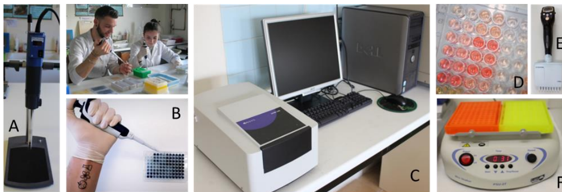
Figura 1.10. Aparatos utilizados para la preparación de muestras y estimación de parámetros bioquímicos y antioxidantes. A: Polytron (T25D Ultra-Turrax, IKA Works Inc., Wilmington, USA); B: Micropipeta y microplaca de 96 pocillos tipo placa ELISA; C: Espectrofotómetro de placas (Asys UVM 340 microplate reader; Biochrom, Cambridge, UK); D: Placa ELISA; E: Micropipeta tipo multicanal; F: Agitador de placas (Thermo-Shaker PST-60HL, Biosan).
