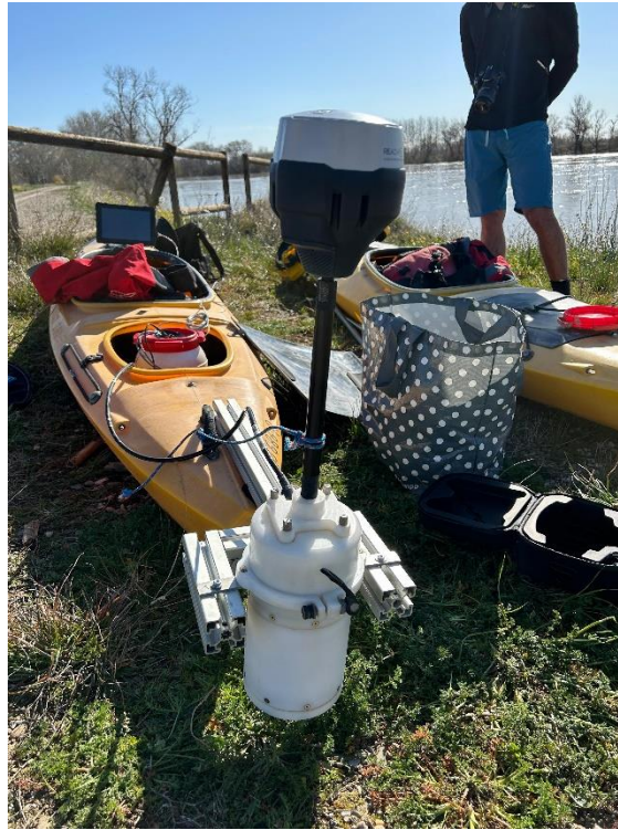
Imagen 4. Sistema ADCP y receptor GPS RTK en la parte trasera de la piragua
