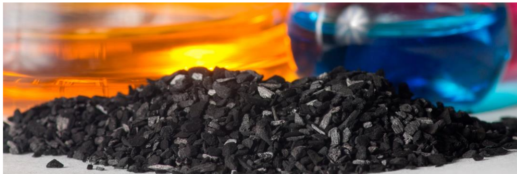
Figura 2. Carbón activado producido a partir de cáscara de nuez
