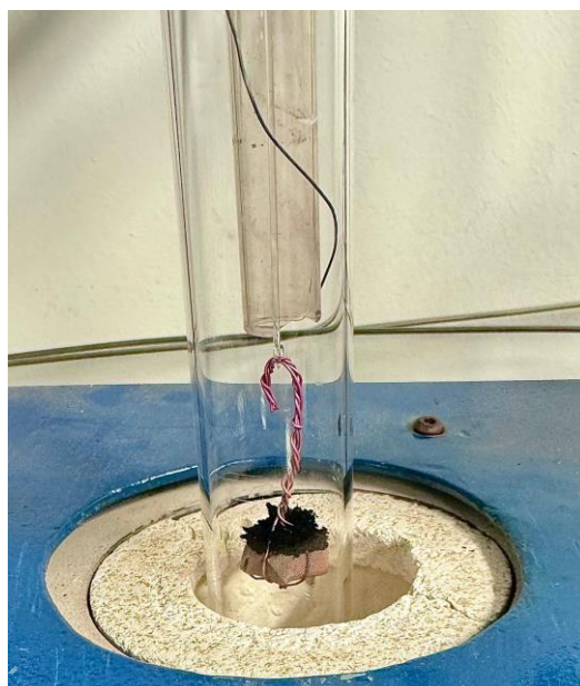
Figura 5- Observación post reacción de la cestilla dentro de los tubos concéntricos de la termobalanza.
