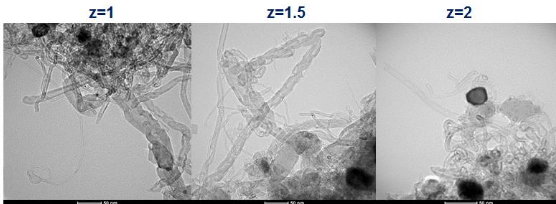
Figura 14 - Imágenes por microscopía electrónica de transmisión (TEM) para la variación de cantidad de Mg en el catalizador.
