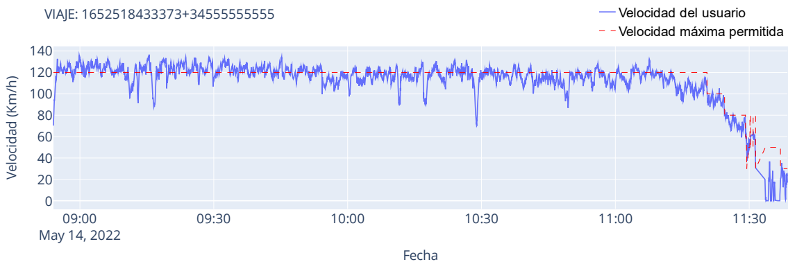
Figura 15. Resultado de aplicar la función de suavizado a la Figura 11.
