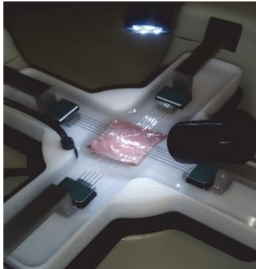
Figura 8: Ensayo de tracción biaxial en una probeta de miocardio porcino [33].
