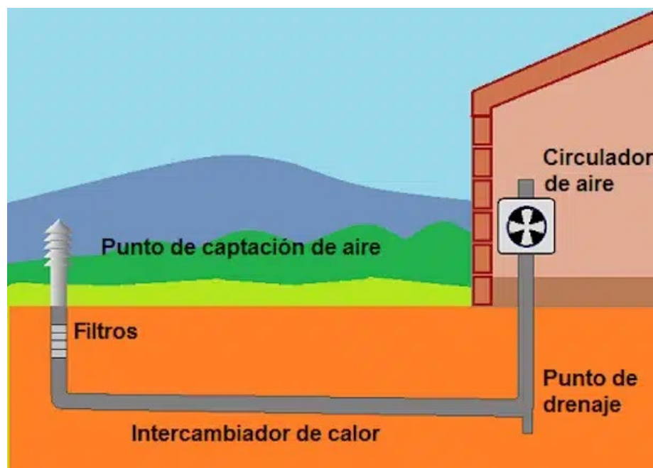
Figura 2: Partes de los pozos canadienses. Fuente: [2].
