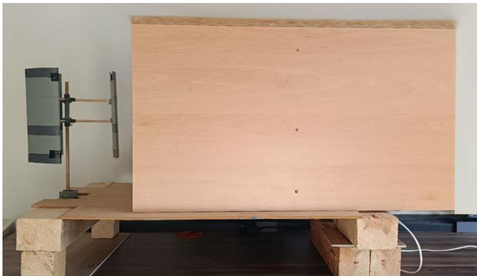
Fig. 53: Vista lateral del montaje completo, turbina eólica y túnel de viento.
