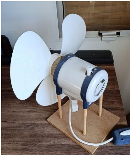
Fig. 51: Ventilador modificado utilizado en los ensayos.
