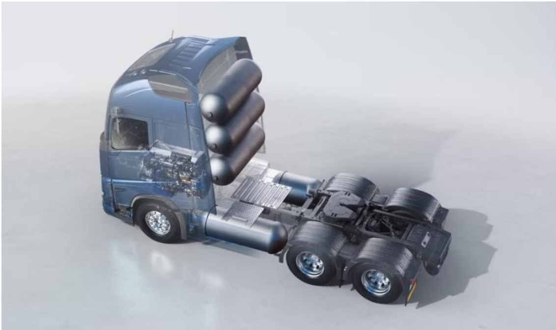
Ilustración 9. Configuración camión con motor de combustión de hidrógeno. Fuente: www.hibridosyelectricos.com
