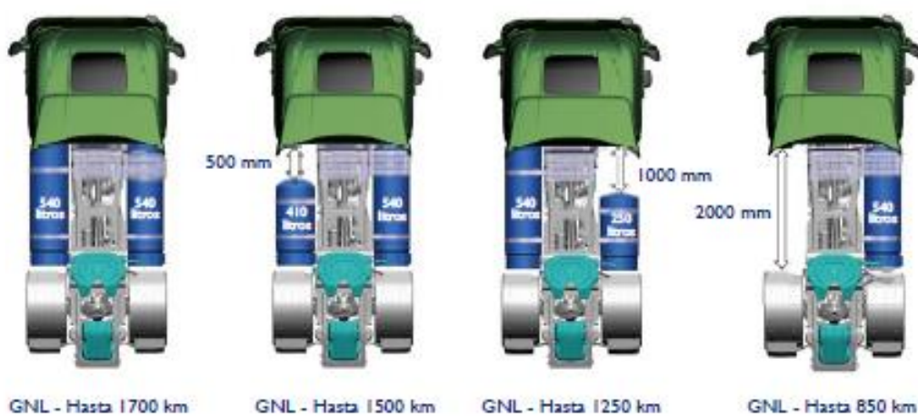
Configuración depósitos GNL. Fuente: www.iveco.com
