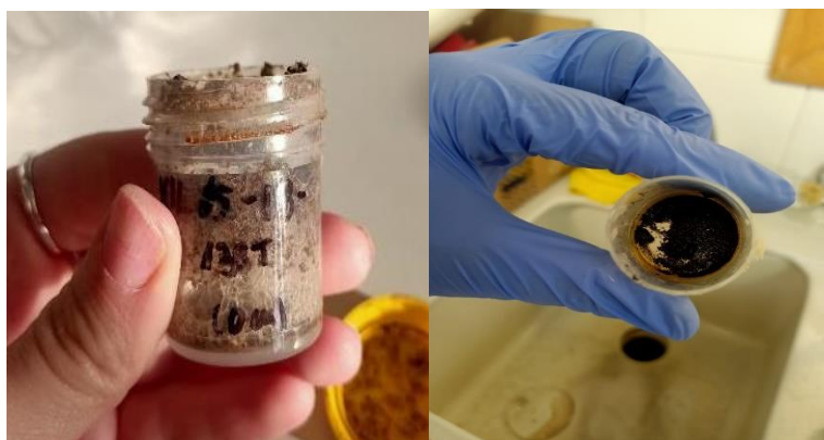
Figura 11. Imágenes de la muestra VIL05-1B-1T-137-0cm: en la de la izquierda, se observa cómo el bote está repleto de burbujas resultantes de la reacción; en la de la derecha, una vez terminada la reacción y lavada la muestra, se observa la gran cantidad de materia orgánica existente todavía
